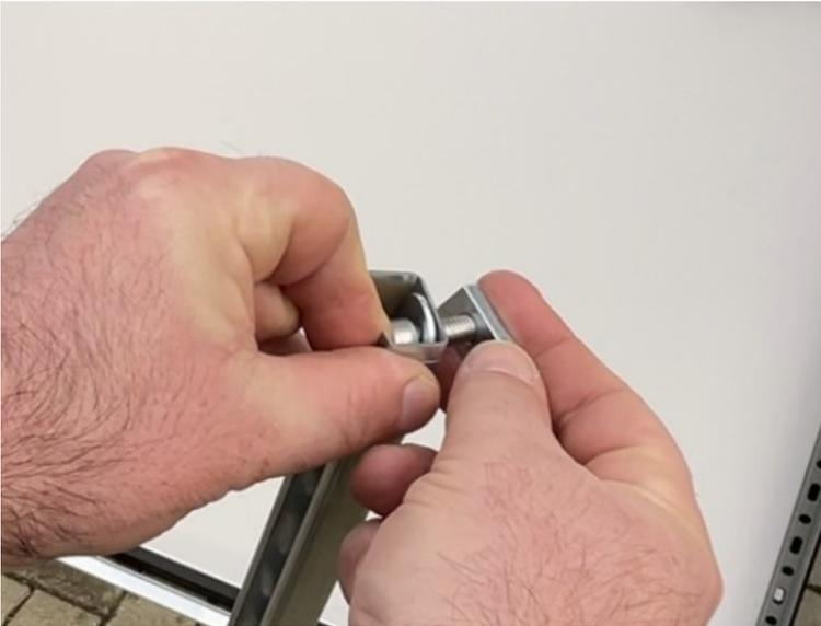
Je 1 Zylinderkopfschraube mit Unterlegscheibe in die äußersten Langlöcher der Stabilisierungsschiene stecken und eine Schiebemutter mit 2-3 Umdrehungen aufschrauben.
