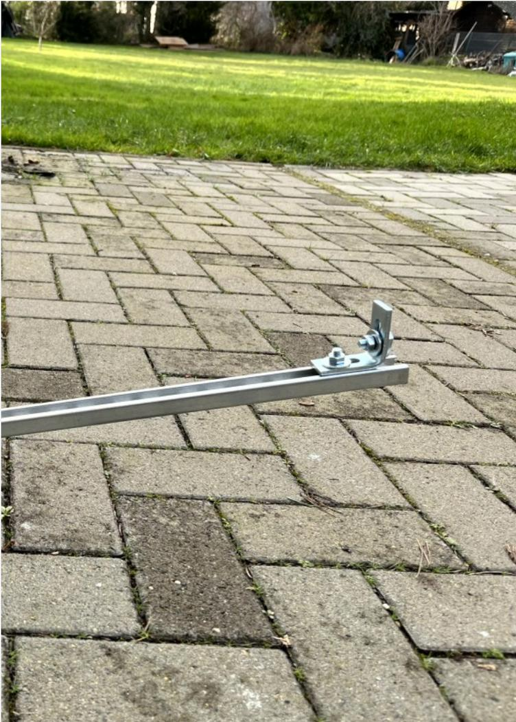
Den Befestigungswinkel mit Hammerkopfschrauben bestücken und den Hammerkopf in das freie Ende der verwendeten Schiene einführen, so dass noch ca. 2 cm Platz zum freien Ende der Schiene ist.
